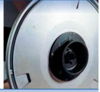
Kettbäume von Scholze Germany stellen in ihrer Verbindung von Rohr, Scheiben und Verschlüssen ausgereifte Konstruktionen für einen dauerhaften und einwandfreien Einsatz und eine hohe Qualität des Endprodukts dar. Sie können mit oder ohne Antriebszahnrad geliefert werden.
